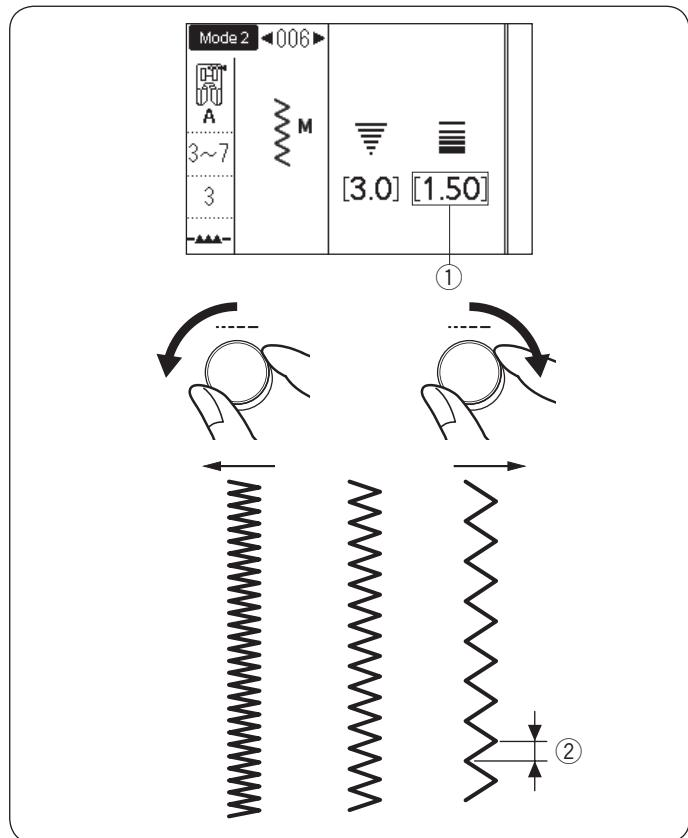
Стежок зигзаг используется для различных целей, включая обмётывание. Его можно использовать, в основном, на всех тканях с волнистыми краями. Плотный зигзаг можно использовать при аппликации.
