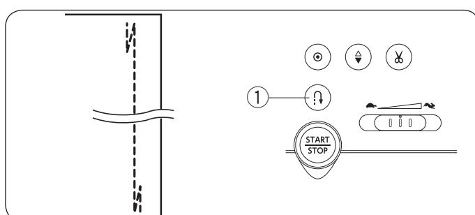
Используйте этот стежок для фиксации шва в начале и конце при помощи закрепки.
