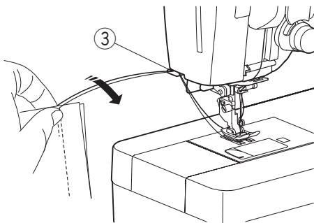
Используйте функцию обрезки специализированных или толстых ниток на лицевой панели машины, если автоматическая обрезка ниток не работает.
