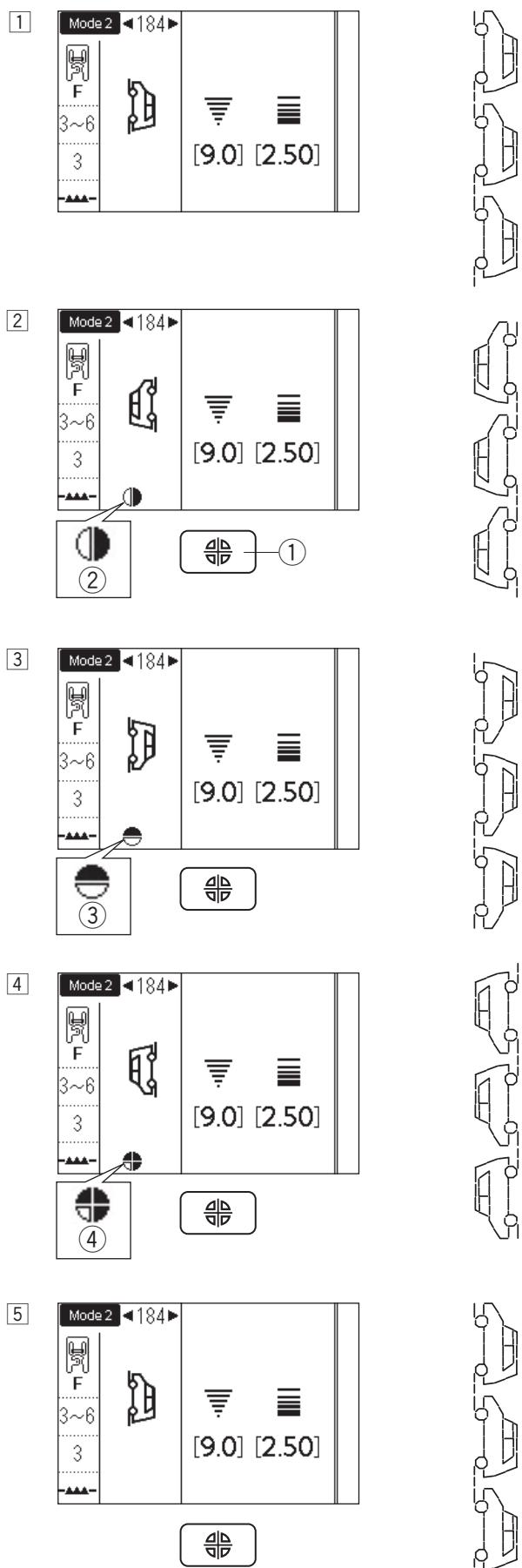
**2** Нажмите кнопку зеркального отображения, чтобы повернуть изображение по вертикали. На экране появится значок вертикального зеркального отображения.
