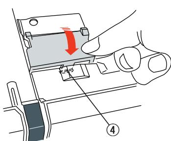
Установите пластину нитенаправителя на машину, вставив язычки в пазы. Надавите на пластину нитенаправителя, чтобы она защёлкнулась на месте.
