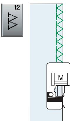
**U12: стежок для сшивания через край — лапка для обметывания М**
