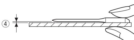
Чтобы проверить прямизну иглы, положите её плоской стороной на ровную поверхность (игольную пластинку, стекло и т.д.).
