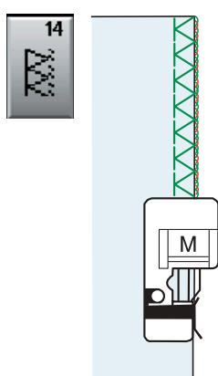
**U14: обметочный стежок — лапка для обметывания М**
