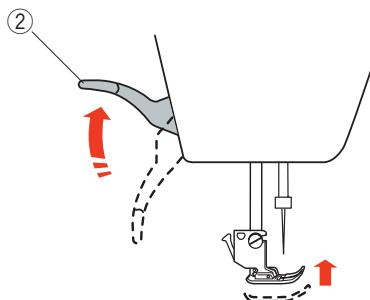
Поднимите рычаг прижимной лапки.
