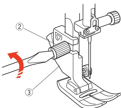
Отвёрткой ослабьте установочный винт и снимите держатель лапки.
