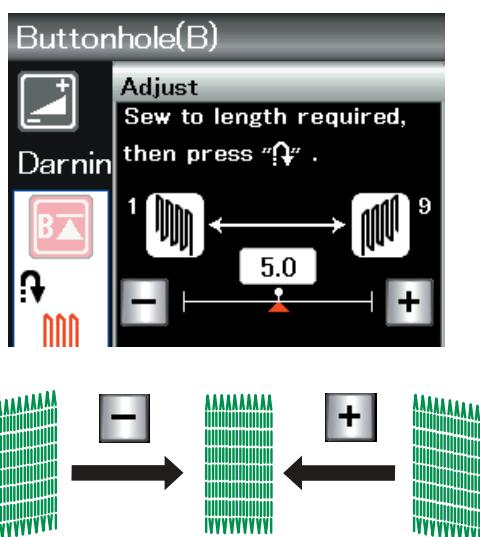
**Чтобы отрегулировать равномерность штопальных стежков**
