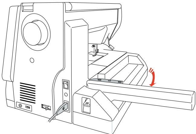
Поворачивайте рычаг каретки наружу до тех пор, пока он не будет выдвинут полностью.
