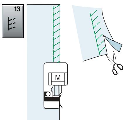
**U13: трикотажный стежок — лапка для обметывания М**
