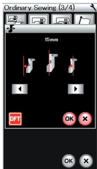
Нажмите клавишу **◀** или клавишу **▶**, чтобы отрегулировать положение направляющей для ткани.
