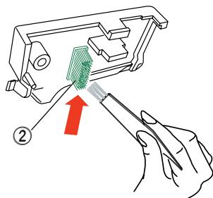
Удалите нитки и пыль со щетки под пластиной нитенаправителя щёткой для очистки от ниток.
