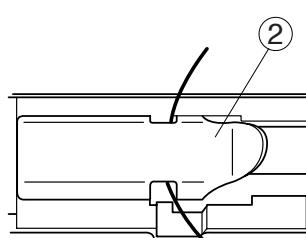
2. Пропустите нить сквозь отверстия нитенаправительной пластины, а далее в первый направитель на машине как показано на рисунке.
