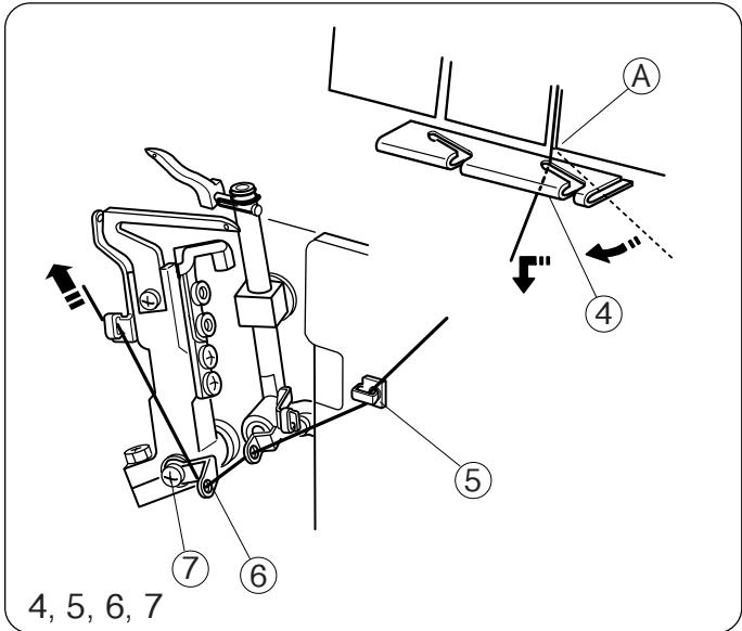
4. Набросьте нить на уголок **(A)**, затем пропустите ее сквозь направитель нижнего петлителя.
