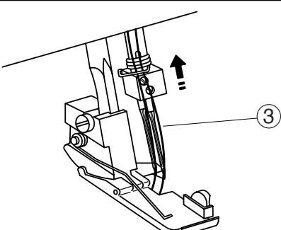
4. При помощи пинцета потяните за нитки под прижимной лапкой и вытяните их поверх игольной пластины. Отведите около 10 см ниток от прижимной лапки. (Вытягивайте игольную нить в направлении А)
