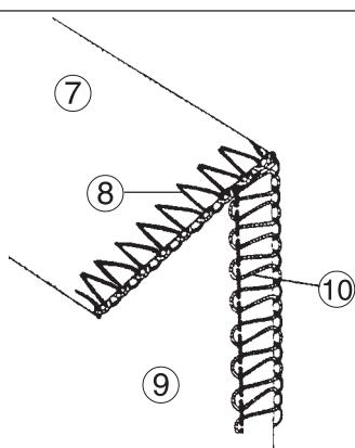
Результат стандартной двухниточной обработки края – на рисунке.
