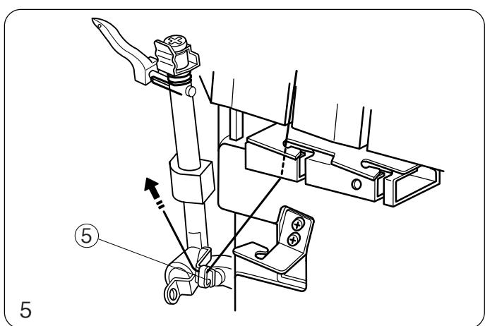
5. Пропустите нить сквозь рычаг нитепрятгивателя верхнего петлителя.
