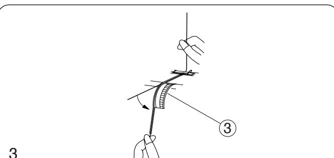
3. Удерживая оба конца нитки, осторожно натяните ее, чтобы она правильно попала между дисками натяжения. (Рычаг подъема прижимной лапки обязательно поднять, тогда нитку легко вставить между дисками натяжения.)
