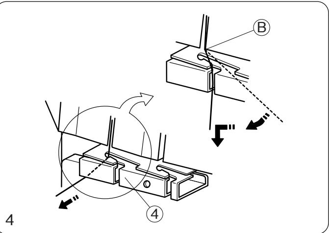
4. Набросьте нить на уголок (B), затем пропустите ее сквозь направитель петлителя.
