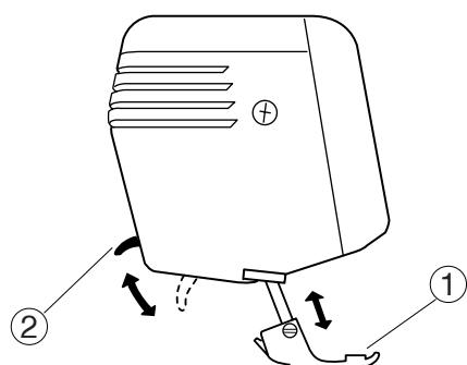
Прижимная лапка поднимается и опускается при помощи рычага подъема лапки.
