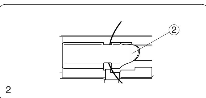
2. Пропустите нить сквозь отверстия нитенаправительной пластины и пропустите ее первый направитель на машине как показано на рисунке.
